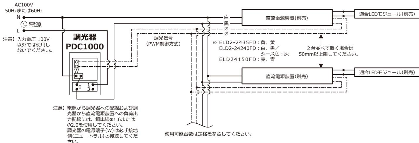
●PWM調光・調色ドライバPDD150DT+直流電源装置を使用する場合(直流電源装置：ELD2475F、ELD24150FD、ELD2-24240FD)
