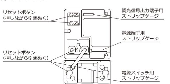
注意】各端子のストリップゲージに合わせて電線をストリップしてください。
