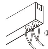
② 結束バンドを持って引き、LEDモジュールを引き出してください。LEDモジュールの端が引き出せたら、LEDモジュール全体を持って本体から取り外してください。
