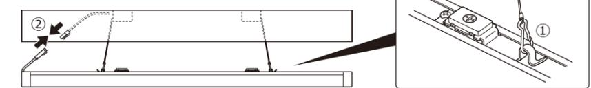
③ LEDコネクタを器具内へ押し込み、電線と落下防止ワイヤーを挟み込まないようにLEDモジュールを押し上げ本体に取り付けてください。
