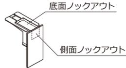
② 器具を連結しない場合はサイド板を取り付けてください。連結する場合は、連結する部分のサイド板を取り外してください。
