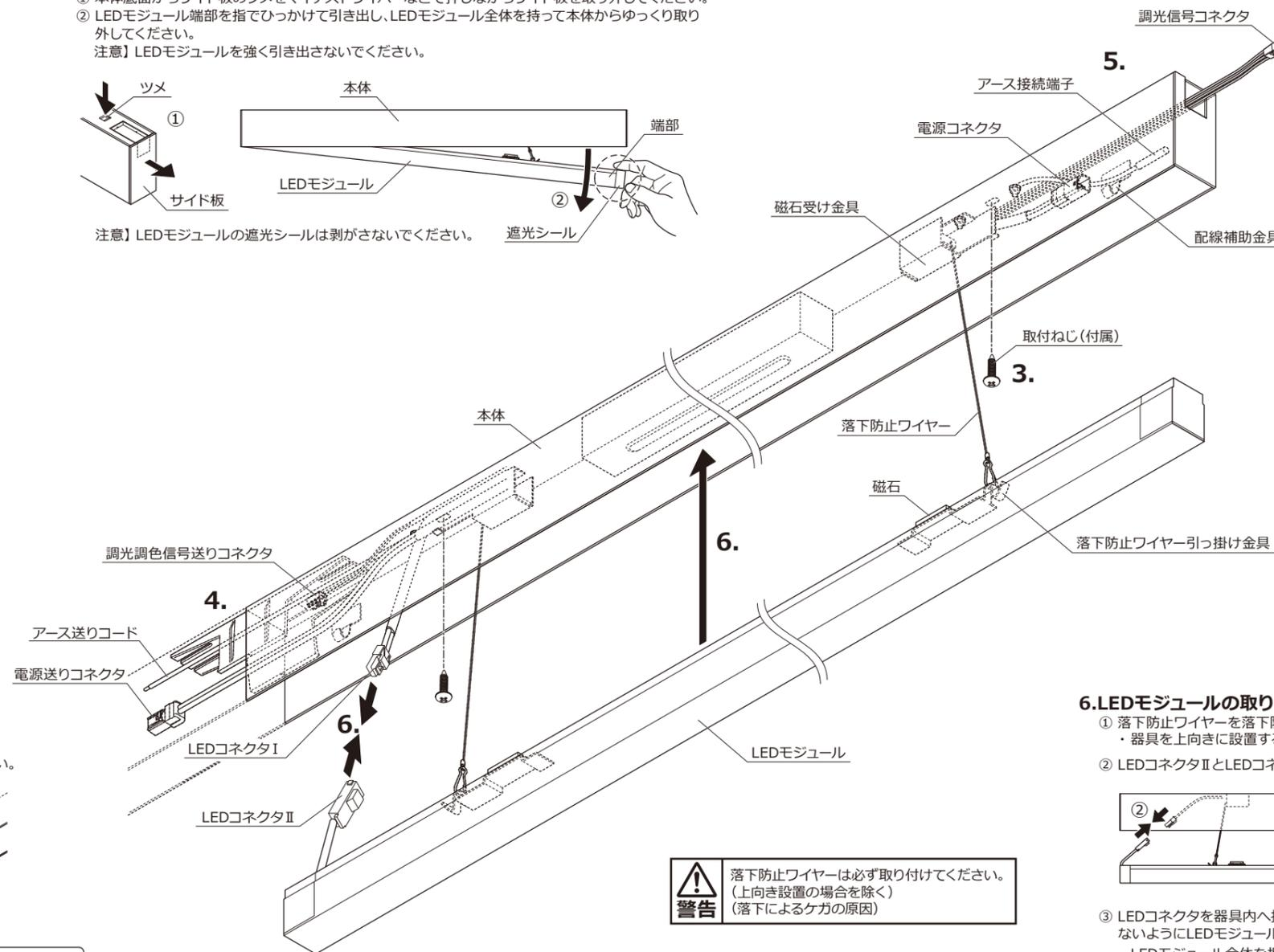
**警告** 落下防止ワイヤーは必ず取り付けてください。(上向き設置の場合を除く)(落下によるケガの原因)
