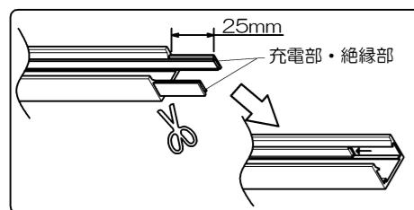
④充電部・絶縁部を引き出し、金切バサミなどで25mm切斷し、レール内に戻し入れます。
