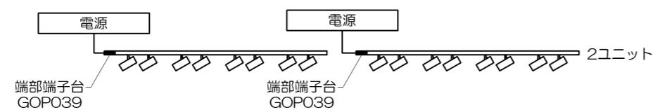
**O** 2ユニット以上に分けて端部端子台GOP039を2個使用し、各々のユニットの総電気容量に適した1台の電源につなげて使用して取付可
