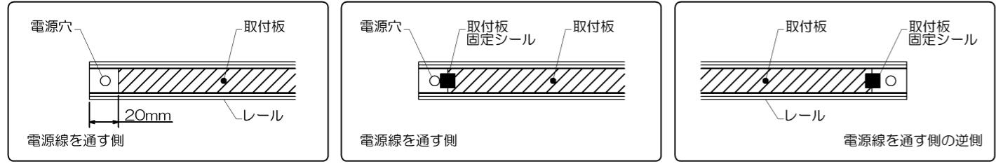
①電源線を通す側の端から、20mmの位置に取付板があることを確認します。
