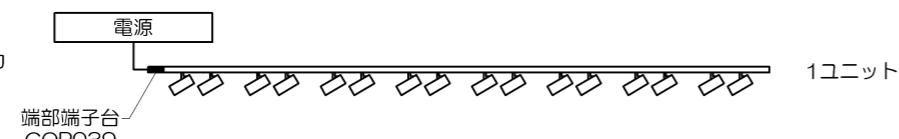
**O** 2ユニット以上に分けて端部端子台GOP039を2個使用し、それぞれの総電気容量に適した電源を使用して取付可
