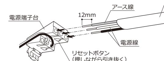
※電源ケーブルを外す場合は、マイナスドライバーでリセットボタンを押しながら引き抜いてください。
