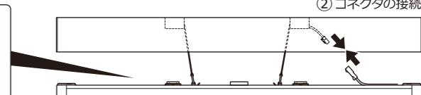
③ LEDコネクタを器具内へ押し込み、電線と落下防止ワイヤーを挟み込まないようLEDモジュールを押し上げ本体に取り付けてください。
