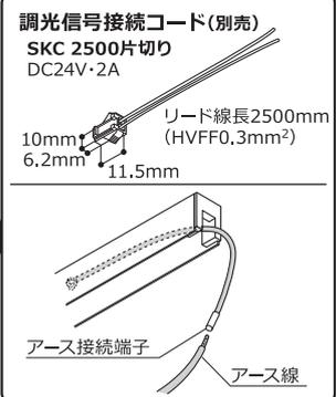
注意] コネクタは器具内へ収納してください。注意] 電源&調光信号の送りをしない場合、送りコネクタは器具内へ収納してください。
