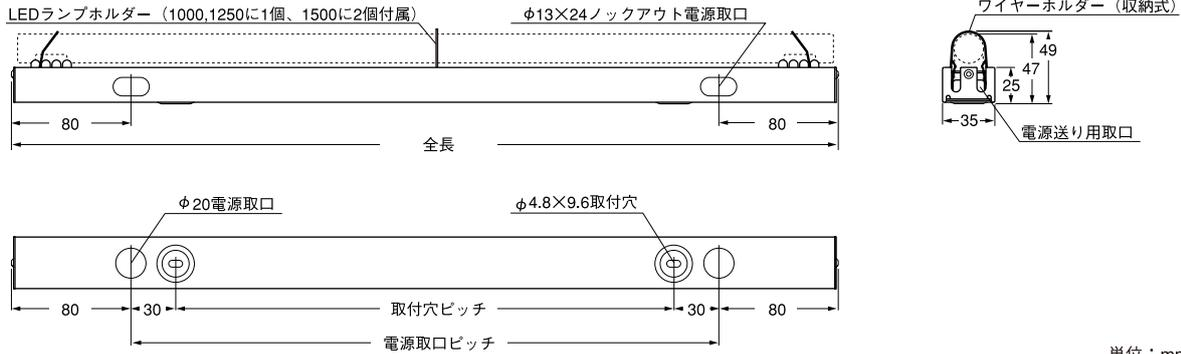
付属品: プッシング 1ヶ、取付用ねじ ( $3.5 \times 20$ mm トラスタッピングねじ 2ヶ)、LEDランプホルダー (500,850は無し) 本体: アルミ (アルマイト仕上げ)
