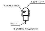
曲がりアルミレールTR2-FXS2-1000C (別売) をLEDモジュールサイズに合わせて切断し、溝に取付穴(φ3.5mm程度)を開け、取付ねじで確実に固定してください。
