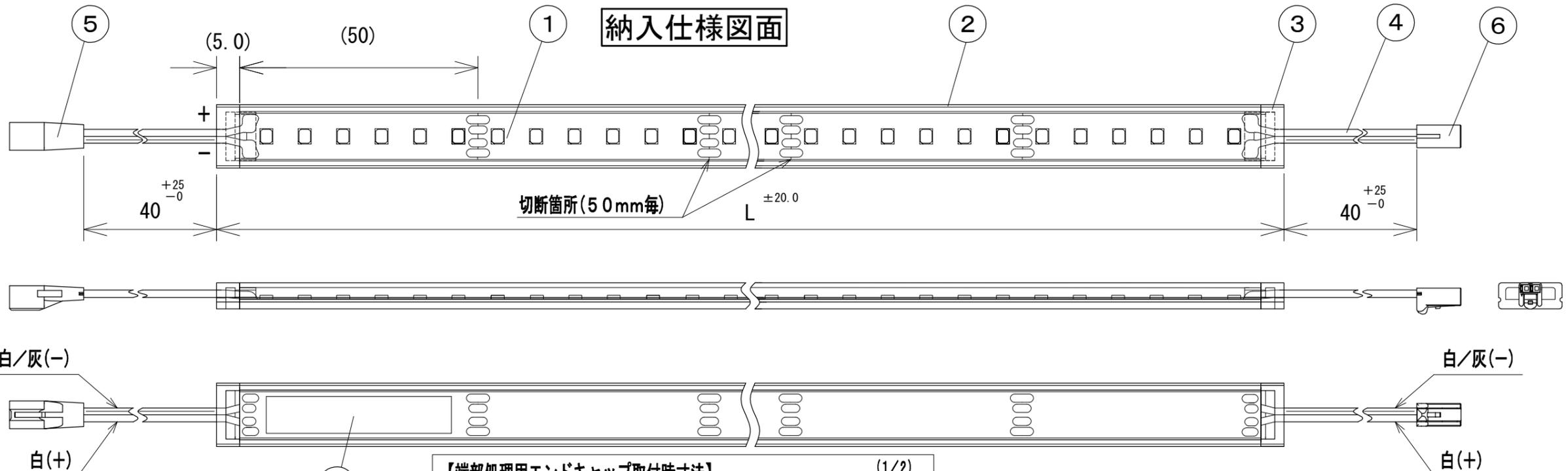
【端部処理用エンドキャップ取付時寸法】 (1/2)
