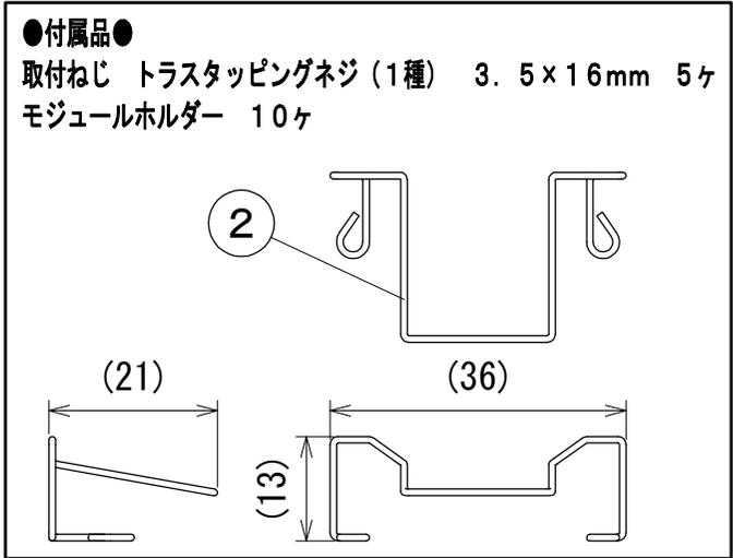
※ LEDモジュールの落下、浮き、位置ずれ防止のため、必ずモジュールホルダーをご使用ください。
