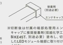
※切断後は付属の端部処理用エンドキャップに推奨接着剤(信越化学工業製KE45T、別途必要)塗布し、切断したLEDモジュール端部に取り付けてください。
