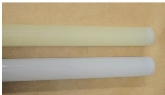
《長期使用により変色した LED モジュールの例》
