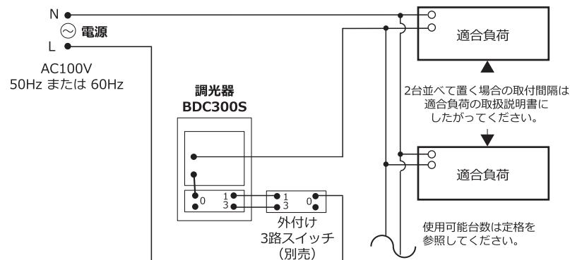
●位相調光ドライバPDD240DB+直流電源装置を使用する場合
